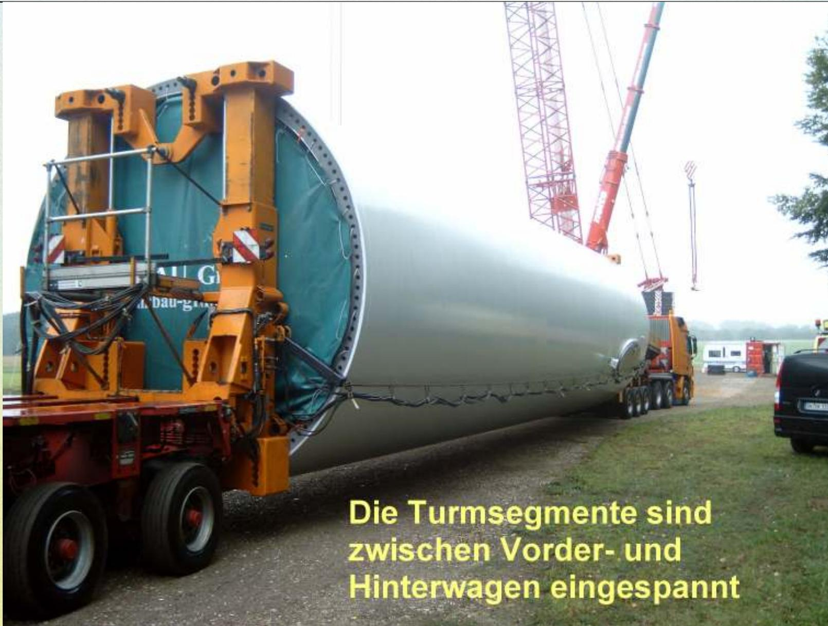
Die Turmsegmente sind zwischen Vorder- und Hinterwagen eingespannt
