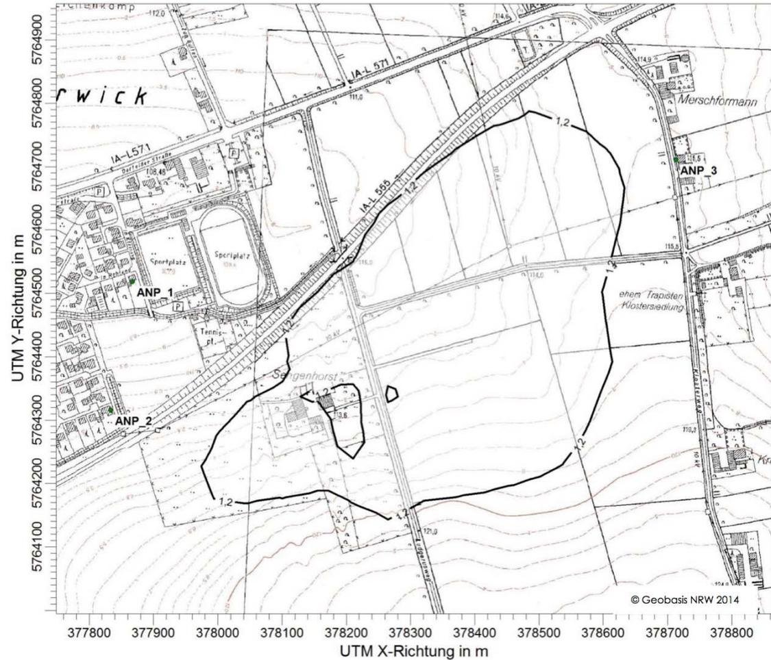
Abbildung 3: Zusatzbelastung Schwebstaub (PM-10) durch den Betrieb Sengenhorst im Planzustand in  $\mu\text{g}/\text{m}^3$
