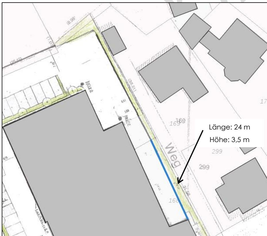
Abbildung 1: Lage der Schallschutzwand im Verladebereich des NORMA
