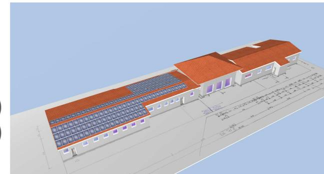
**Variante 3/4:** Photovoltaikanlage O/W Ausrichtung (**9,6 kWp**) + Speicher (**4,8 kWh**)
