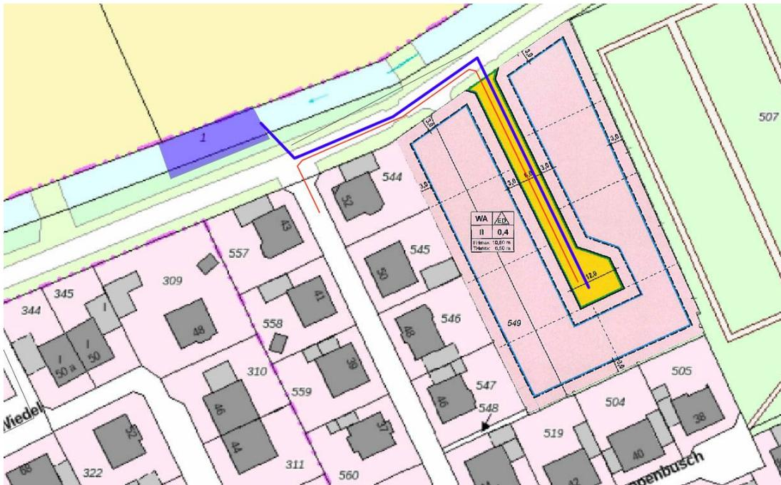
Abb. 13: Leitungstrassen zusammen mit dem B-Plan-Entwurf, blau markiert die Aufweitungsstrecke im Gewässer 555
