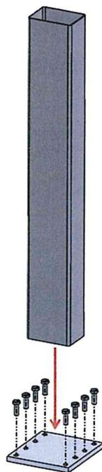
Der Fuß wird mit der Grundplatte verschweißt
